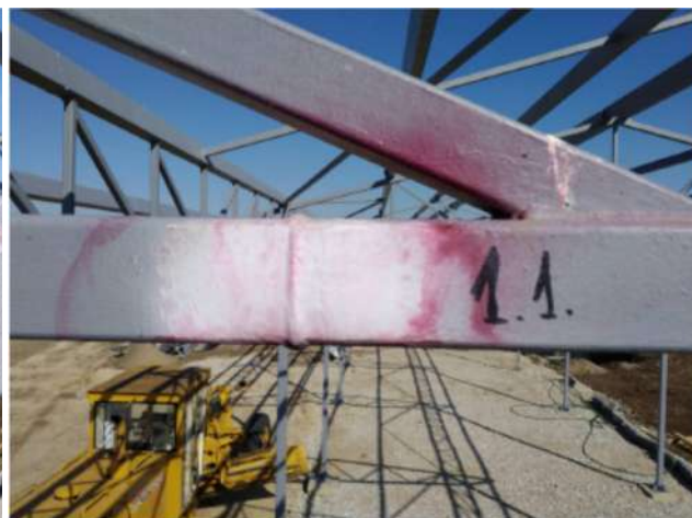
nanošenje razvijlača (nema vidljivih grešaka)
